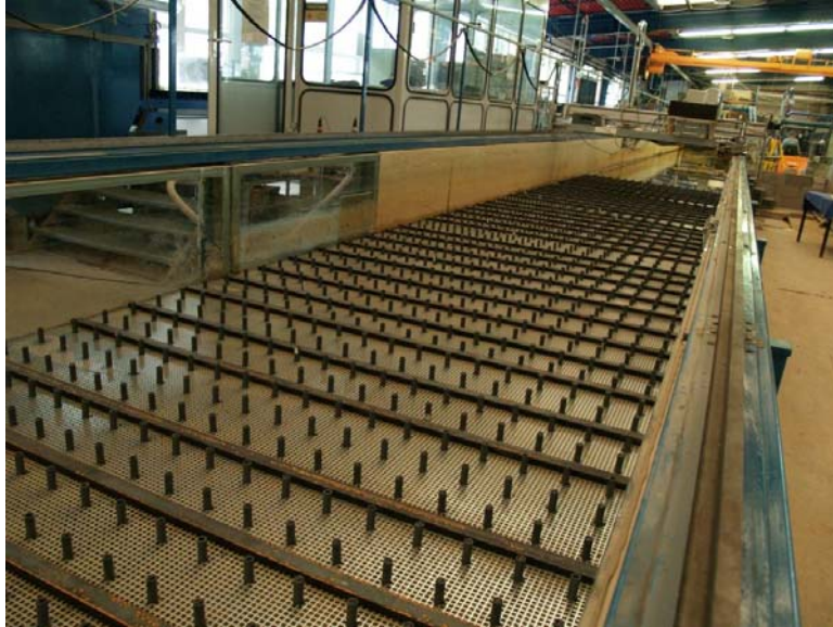
Abb. 10: Blick auf die Pflanzenbefestigung. Hierzu wurden über 1500 Hülsen auf 12 Lochblech-platten aufgeschraubt. Die so erzeugte flächenhafte Sohlrauheit entspricht den im Feld ermittelten Naturwerten.
