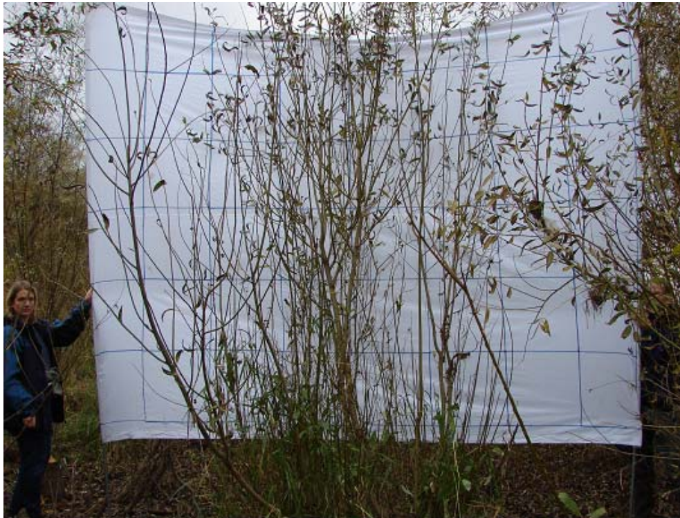
Abb. 8: Aufnahme einer jungen Weide vor dem Rasterrahmen. Mit Hilfe solcher digitalen Fotos wird bei Verwendung von Bildbearbeitungssoftware die Ableitung der hydraulisch relevanten Vegetationsparameter möglich.
